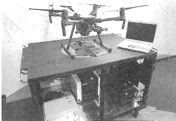
点検装置は発着台「D-road」と制御システム、ドローン、画像解析ソフト、ノートパソコンなどで構成
